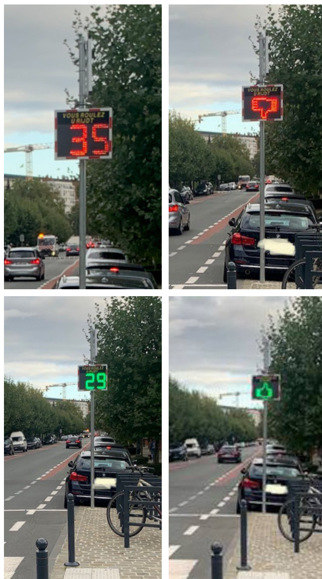
Figuur 6: Weergave in rood en groen (met pictogrammen) zodat de weggebruiker de boodschap gemakkelijk begrijpt
