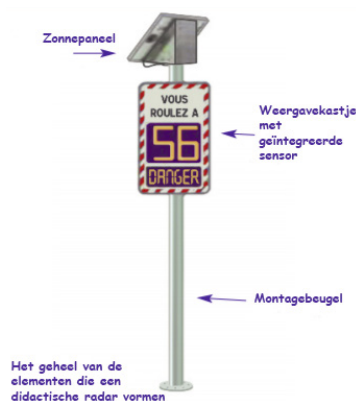
Figuur 4: Alle onderdelen van een preventieve snelheidsradar [Cerema]
