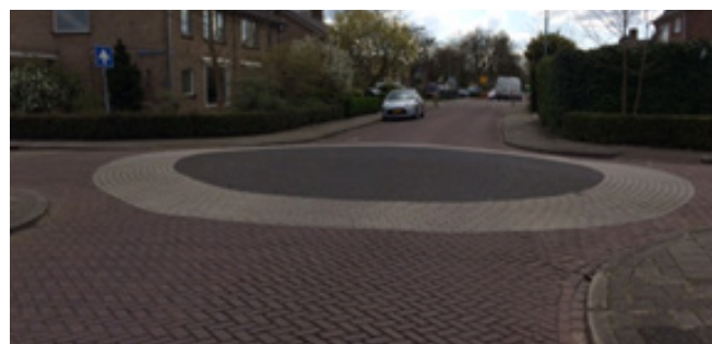
Figuur 12: Volledig overrijdbare inrichting
