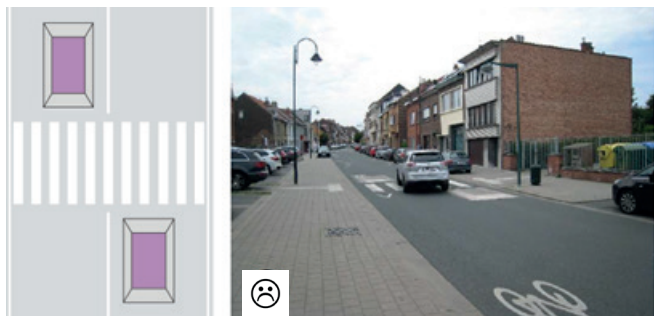
Figuur 6: Gevaar voor onaangepast gedrag bij rijbaankussens met zigzagdoorgang zonder fysieke scheiding [OCW 2020_1]
