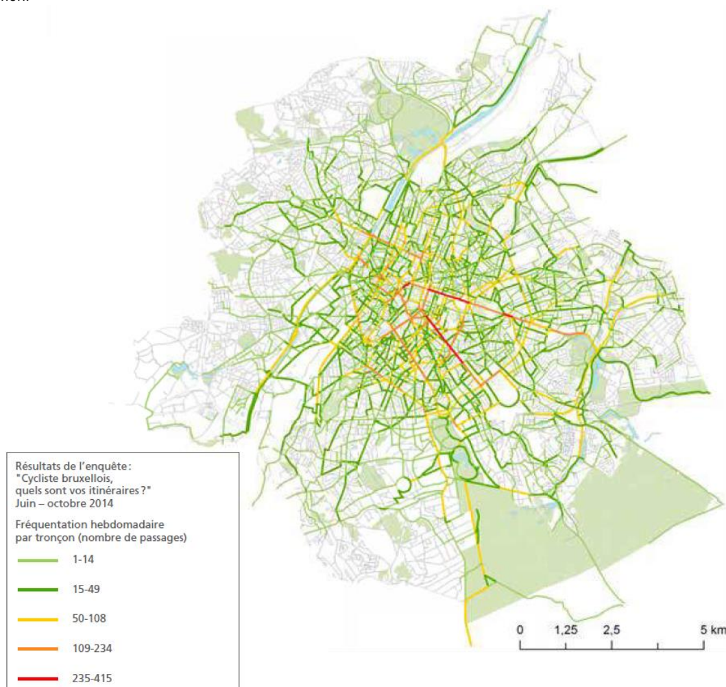
FIGUUR 85: FIETSERSSTROMEN IN HET BHG IN 2014 OP BASIS VAN TELLINGEN (KATERN VAN HET KENNISCENTRUM VAN DE MOBILITEIT, 2016)
