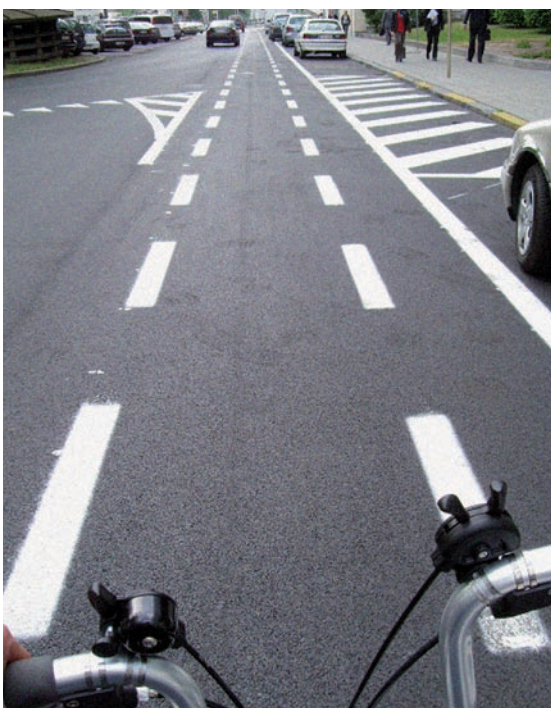
Piste cyclable marquée. Dans ce cas, le marquage permet au cycliste de garder sa priorité au croisement
