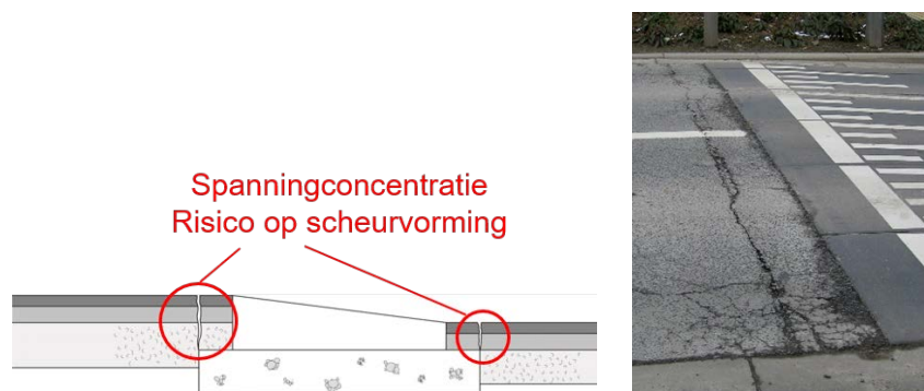
Afbeelding 85: Ontstaan van scheuren ter hoogte van de voeg tussen verschillende funderingen
