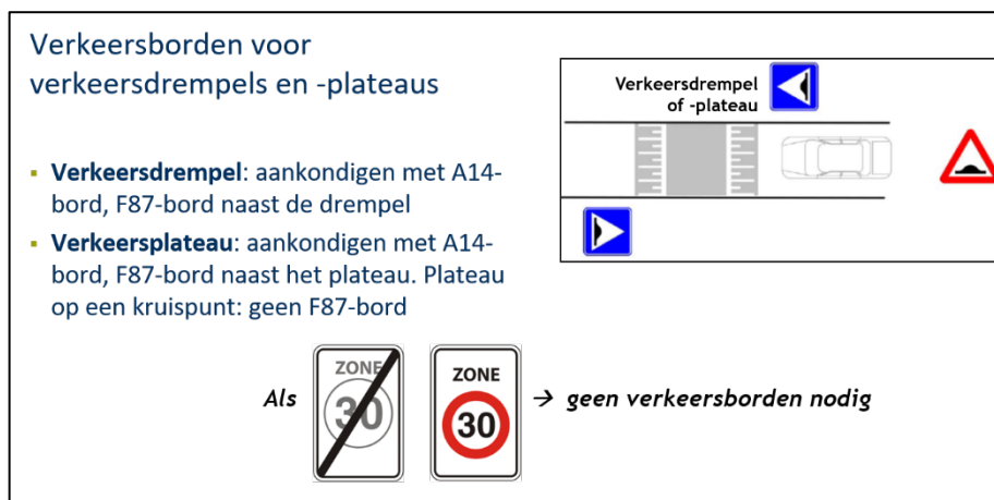
Afbeelding 46: Samenvatting van de verticale signalisatie die wordt voorzien bij de aanleg van verkeersplateaus of -drempels op een openbare weg
