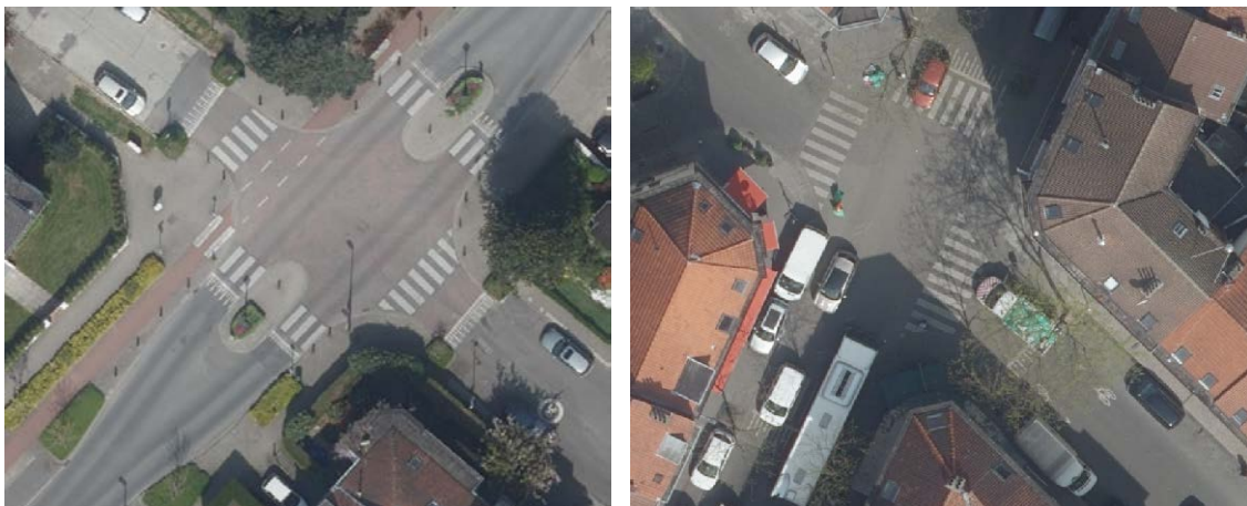
Afbeelding 38: Onvoldoende afstand tussen de kammarkering van de opritten en de markering van de voetgangersoversteekplaats - Kruispunten tussen de Grootveldlaan en de Montgolfierlaan in Sint-Pieters-Woluwe (foto links), tussen de Wijnheuvelestraat en de Trooststraat in Schaarbeek (foto rechts)
