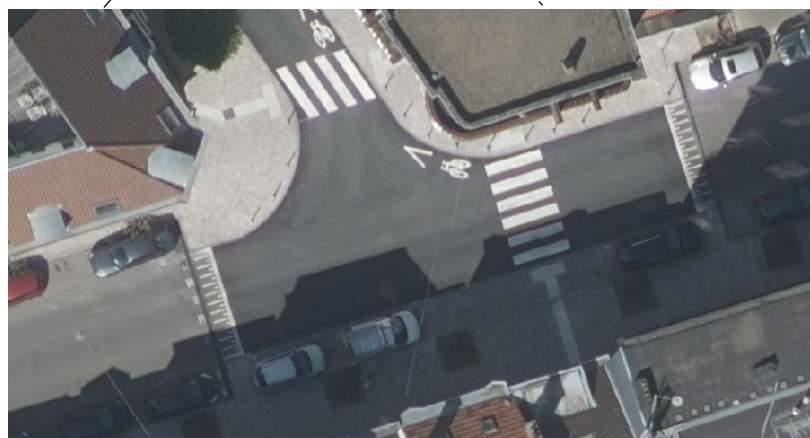
Afbeelding 23: Aanleg van verkeersplateaus op een kruispunt, rekening houdend met de onderlinge zichtbaarheid tussen voetgangers en gemotoriseerde gebruikers (parkeren wordt enkel na de invoering van specifieke maatregelen toegestaan)
