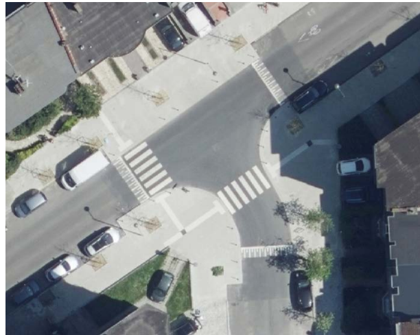
Afbeelding 22: Beperking van de afstand tussen de kam en de voetgangersoversteekplaats door de lokale context: positionering van de oversteekplaatsen volgens de natuurlijke weg van de voetgangers en de locatie van de op- en afritten, rekening houdend met de berijdbare inritten en het behoud van het parkeren.
