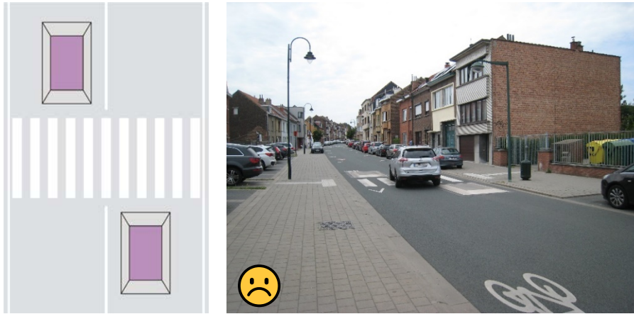
Afbeelding 69: Risico op ongepast gedrag in aanwezigheid van rijbaankussens met een zigzagdoorgang zonder fysieke scheiding
