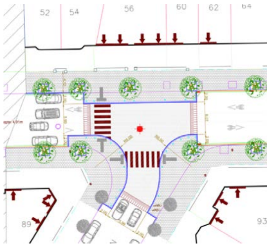
Afbeelding 22: Beperking van de afstand tussen de kam en de voetgangersoversteekplaats door de lokale context: positionering van de oversteekplaatsen volgens de natuurlijke weg van de voetgangers en de locatie van de op- en afritten, rekening houdend met de berijdbare inritten en het behoud van het parkeren.
