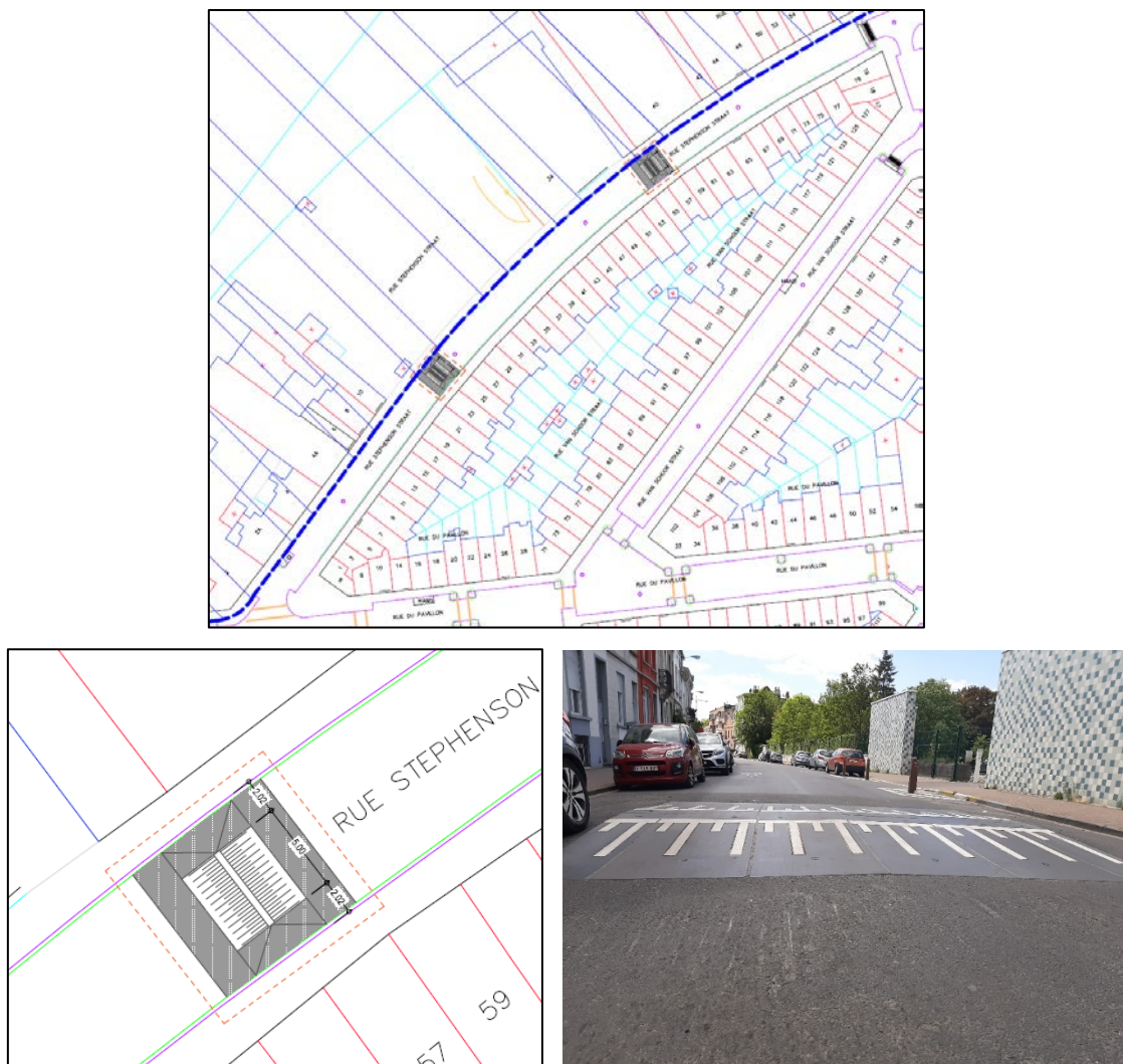
Afbeelding 58: Aanleg van twee verkeersdrempels (lengte: 4,8 m en hoogte: 12 cm) met behulp van geprefabriceerde op- en afritten in de Stephensonstraat
