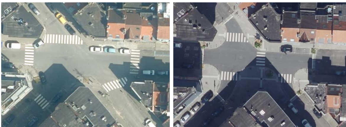
Afbeelding 36: Verkeersplateau aangelegd op een kruispunt, waardoor enerzijds de voetgangersoversteekplaatsen kunnen worden ingekort en geherpositioneerd volgens de natuurlijke weglijnen en anderzijds de toegankelijkheid kan worden verbeterd en de snelheid kan worden verminderd (kruispunt Gerlachestraat en Haerestraat in Etterbeek).
