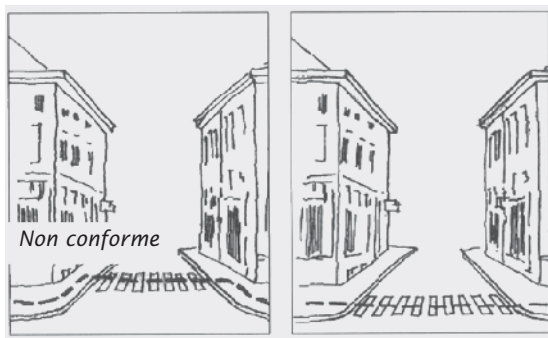
Figure 13 – Norme de positionnement des traversées
