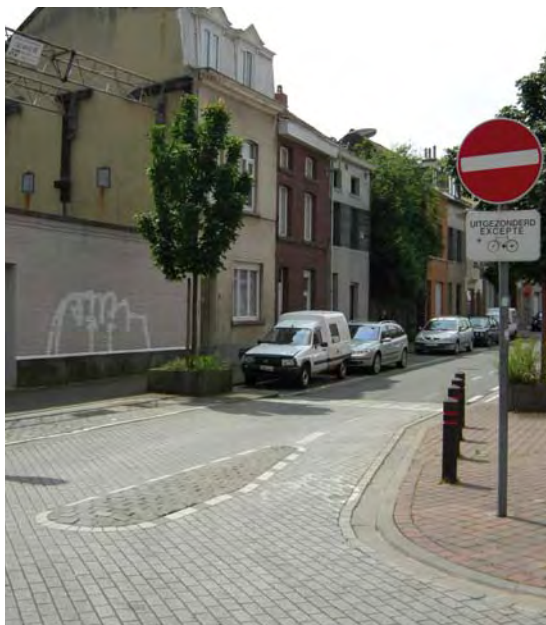
Figure 5.5. – Un îlot directionnel ou un bourrelet comme illustré ici renforcent la présence des cyclistes tout en écartant les véhicules motorisés de leur trajectoire. Ils peuvent compléter un marquage.
