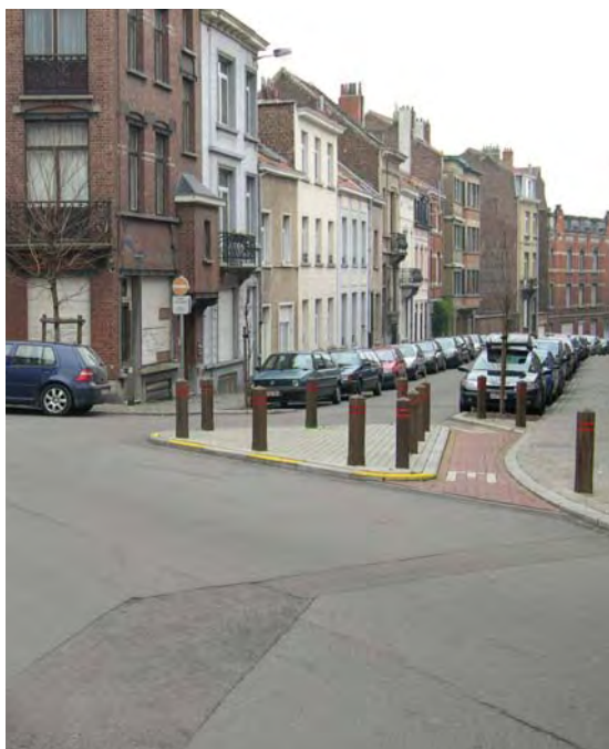
Figure 9.1. – Extension de trottoir avec «by-pass» cyclable en entrée de contresens cyclable.
