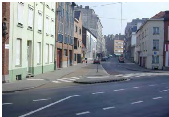
Figure 9.2. – Îlot en sortie de contresens cyclable.
