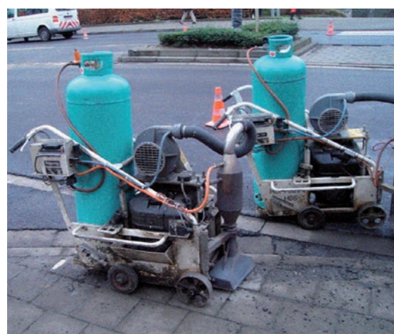
Apparatuur voor het drogen van het te markeren oppervlak
