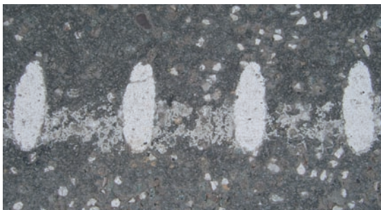
Ribbelmarkering van kleine opstaande blokken
