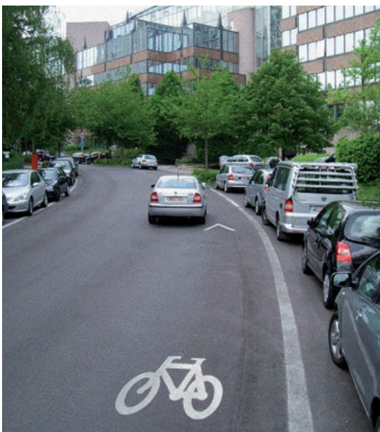
Fietssuggestiestrook. Afwisselende markering van fietslogo's en sergeantstrepen bakent het fietstraject af
