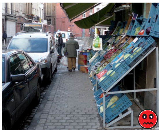
Libre passage continu inférieur à 2 m au niveau des étals.
