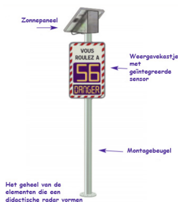
Figuur 4: Alle onderdelen van een preventieve snelheidsradar [Cerema] Bron: DSCR/DCA
