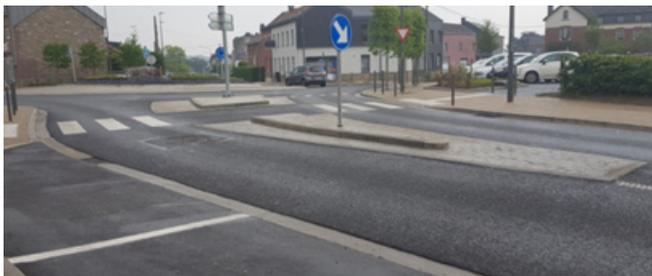
Figure 1 : Îlot central avec un refuge pour les piétons (le marquage du passage pour piétons aurait pu être prolongé sur la partie franchissable de l'îlot)
