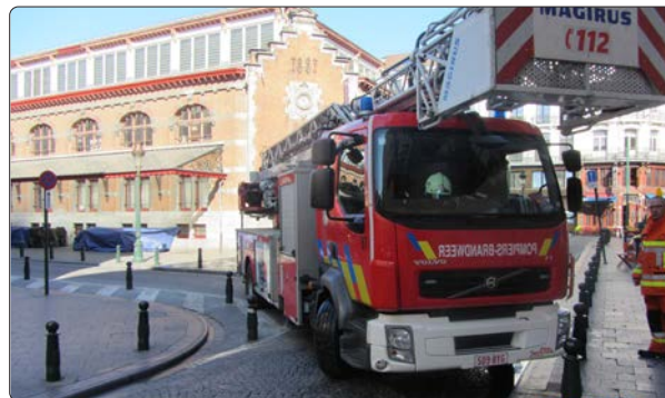
Problématique de giration liée à la présence des potelets et du panneau de signalisation.
