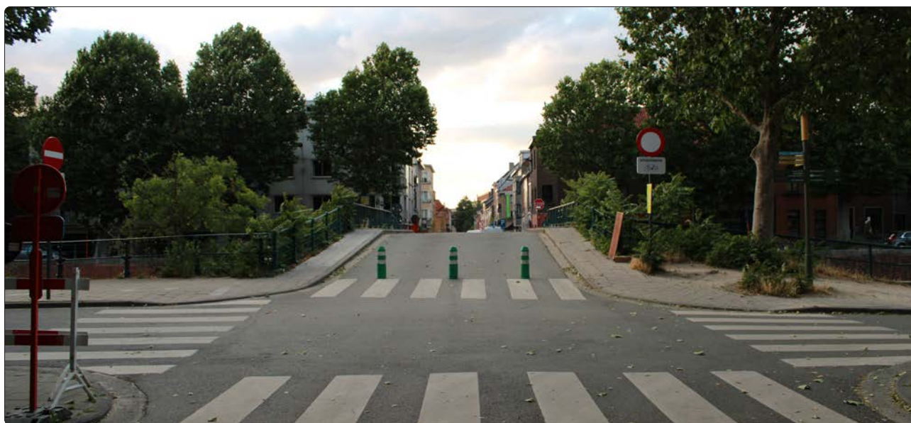
Coupure physique matérialisée par des potelets et empêchant tout franchissement par un véhicule motorisé et donc également par ceux des services de secours.
