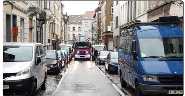
Chaussée trop étroite ne permettant pas à l'auto-échelle de déployer ses vérins
