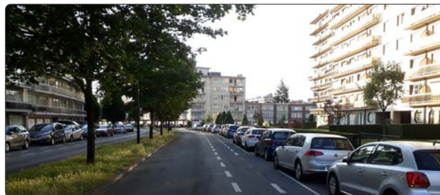
La façade du bâtiment est située à plus de 10 mètres de la chaussée, ce qui ne permet pas à l'auto-échelle de l'atteindre.
