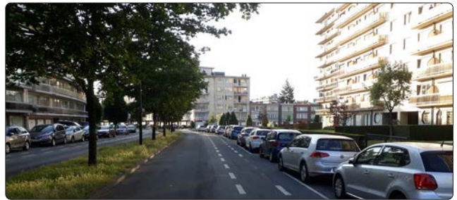
De gevel van het gebouw staat op meer dan 10 meter van de rijbaan, waardoor de ladderwagen hem niet kan bereiken.
