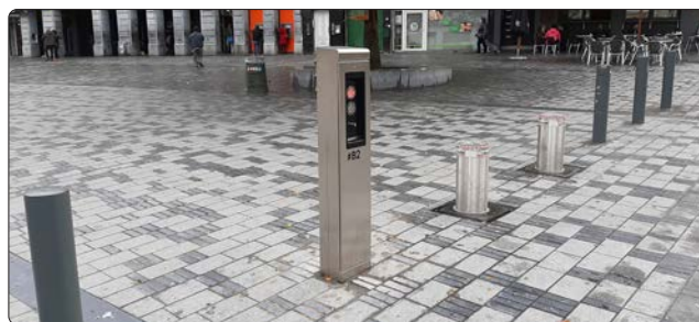
Automatische verdwijnpalen die de toegang tot het Sint-Gillisvoorplein beperken.
