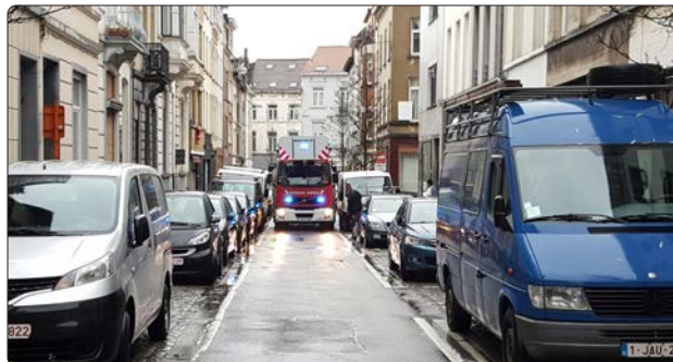
Te smalle rijbaan waarop de ladderwagen zijn vijzels niet kan uitschuiven.
