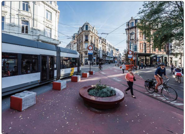
Knip d.m.v. een rode markering en een aangepaste signalisatie die de automobilist aanspoort rechts te houden. Een ANPR-camera vóór de knip controleert de overschrijding ervan.
