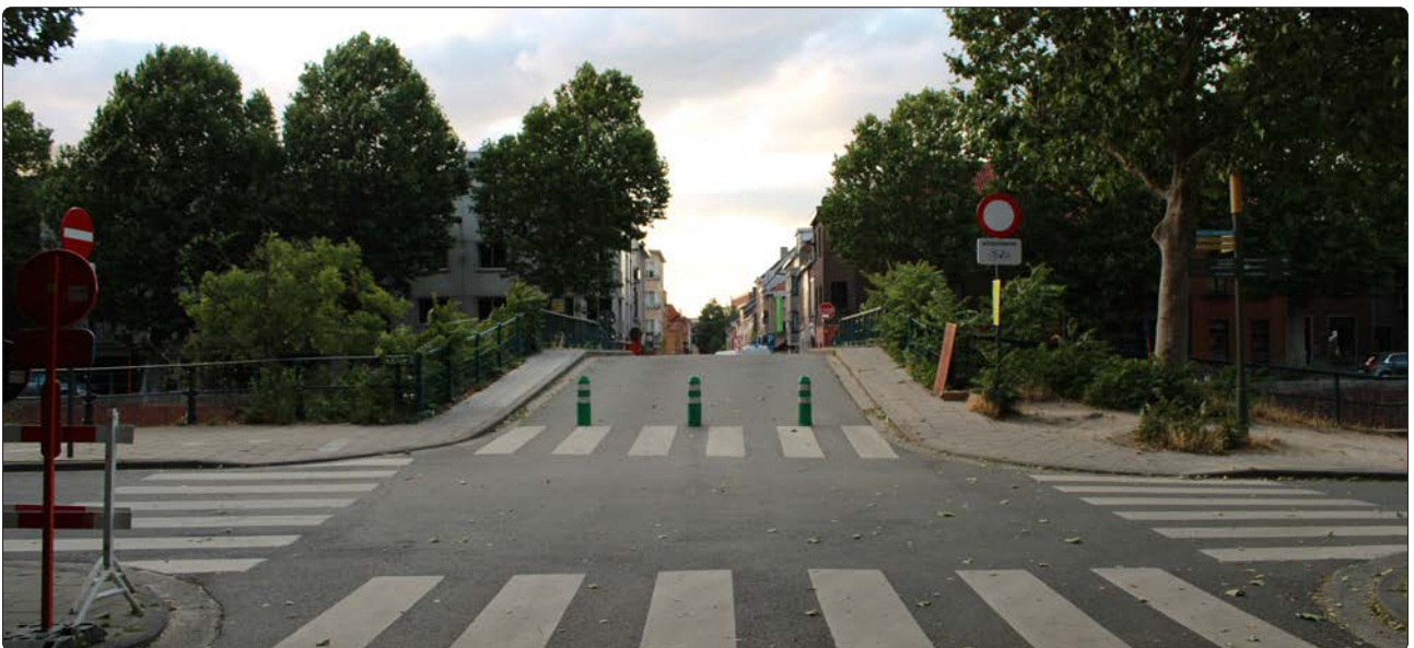
Fysieke afsluiting d.m.v. paaltjes die elke overschrijding met een motorvoertuig verhinderen en dus ook de voertuigen van de hulpdiensten.
